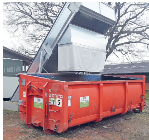
Der Kot wird über den Schieber zum Stall-Ende transportiert und von dort in einen Sammelcontainer überführt.
